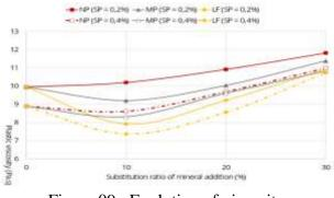
Figure 09 : Evolution of viscosity en fonction of mineral addition
