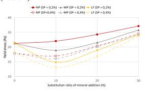
Figure 08 : Evolution of yeld stress en fonction of mineral addition
